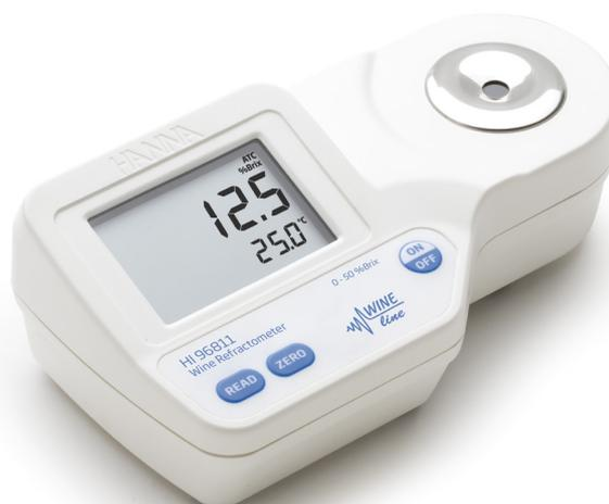
**HI 96811** mesure l'indice de réfraction des échantillons et le convertit en unités % Brix.
